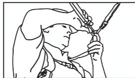
L'Alupercha permet au travailleur de changer d'ancrage avant de se décrocher de la première potence Alupercha, de manière à ce que la sécurité soit maintenue à tout moment.
