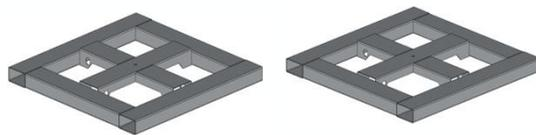
**BASES** : Vérifier les éventuelles déformations, les passages de fourches et les anneaux de levage.
