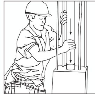
2- 36 heures après avoir bétonné le poteau, l'Alsipercha peut être utilisé pour placer les panneaux, barrières de sécurité, cloisons, etc.
