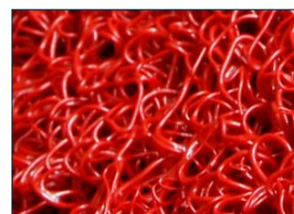
Rouleau de vinyle non absorbant spécialement conçu, extrudé à partir de PVC 100% et thermofixé. Sans DOP.
